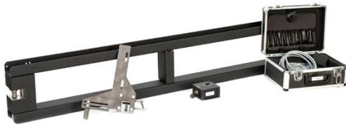
PG3 System wird für einen höchst präzisen Einbau von Schienen verwendet. Mit der Verwendung dieser Vorrichtung kann ein höchst präziser paralleler und diagonaler Einbau von Schienen erreicht werden.
