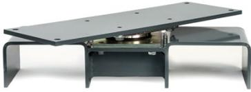
Als 2in1 Hilfsmittel kann der Drehteller zweifach verwendet werden. Durch die 360° drehbare Auflagefläche kann es für den Transport mit einem Hubgabelstapler von langen Gegenständen in engen Räumlichkeiten (z.B. Fluren) oder auch für das An- und Abrollen von großen Seil- und Kabelrollen verwendet werden. Für das Auf- oder Abrollen von großen Seil- und Kabelrollen muss ergänzend eine Holz- oder Metallplatte angebracht werden.
